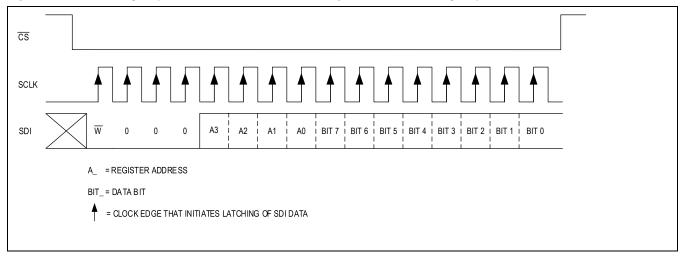
Figure 10. SPI Write Byte
