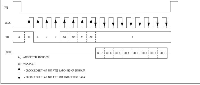
Figure 11. SPI Read Byte
